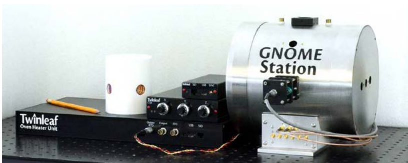
Նկար 6. Էկզոտիկ ֆիզիկական երևույթների որոնման համար մագնիսաչափերի համընդհանուր ցանցի (GNOME) ծրագրով մշակված 3 \cdot 10^{-15} S-ի զգայնությամբ օպտիկական մագնիսաչափը
