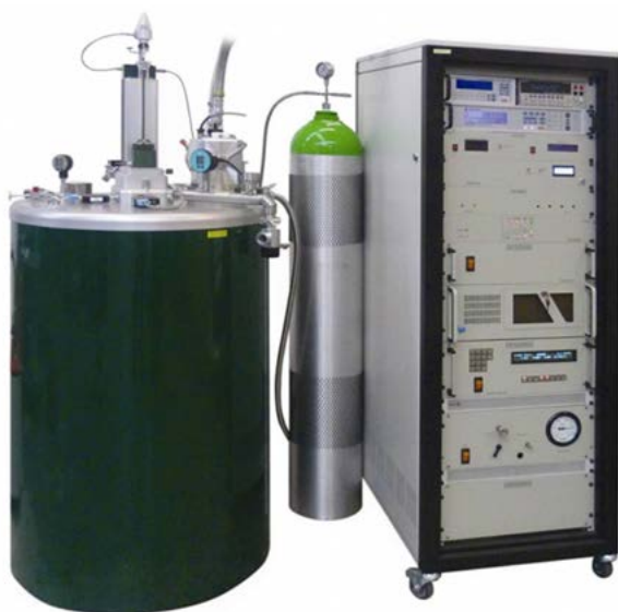
Նկար 2. Cryogenic ընկերության S700X SQUID մագնիսաչափը
