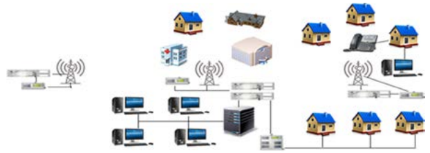
Նկ. 4. WiMax տեխնոլոգիայով հեռաբժշկական ցանցերի միավորման օրինակ
