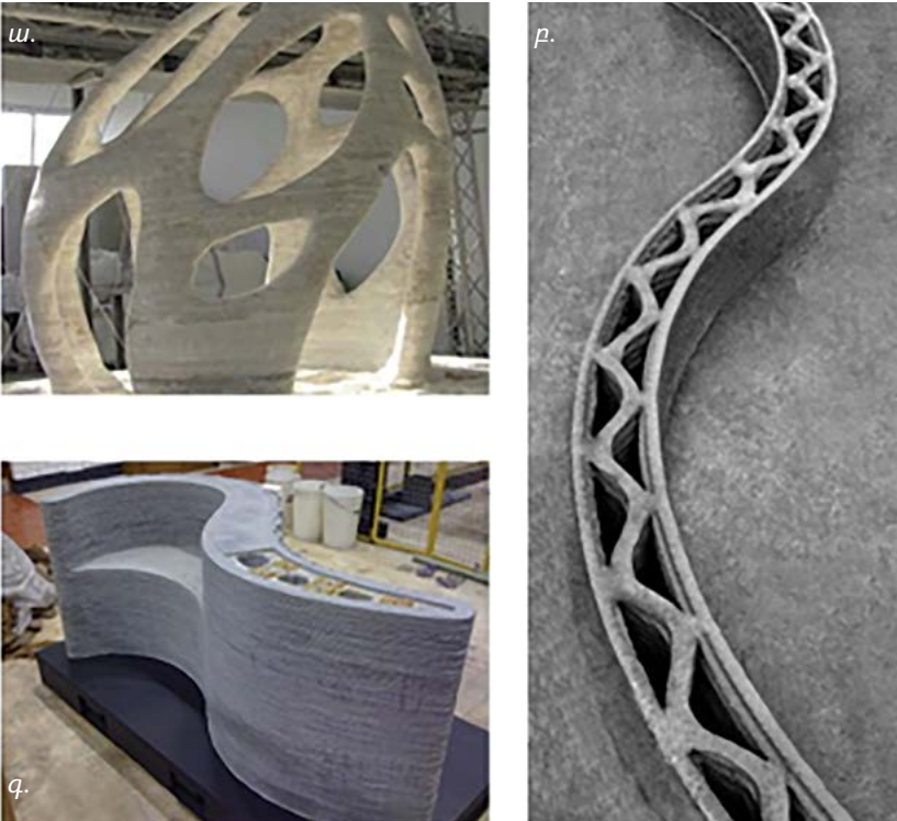
Նկ. 9 3D-տպագրությամբ ստեղծված տարբեր պատրաստվածքներ, ա. D-ձև, բ. եզրագծի ստեղծում, գ. բետոնի տպում
