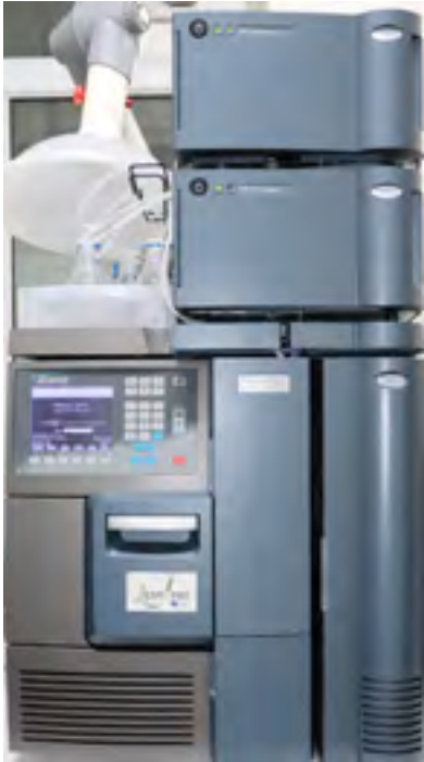
Նկ. 1 Հեղուկային քրոմատոգրաֆիչի սրբաքիչի տեսքը
