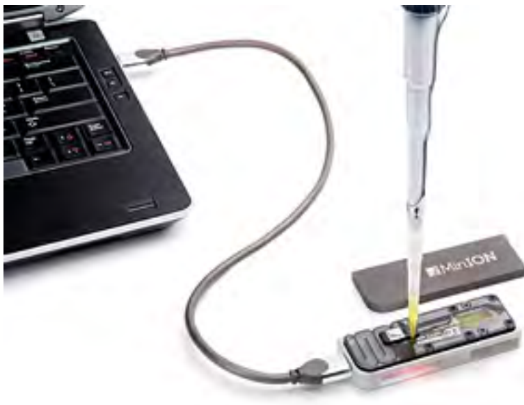
Նկար 1. Նանոձակոտկենային սեքվենավորման MinION սարքը՝ միացված համակարգչին
