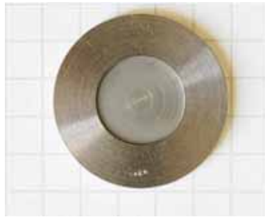
Նկար 13. Տիտանի սկավառակում մամլված մոլիբդենի փոշին և լազերային մշակման հետևանքով առաջացած ցանցաձև ակոսները
