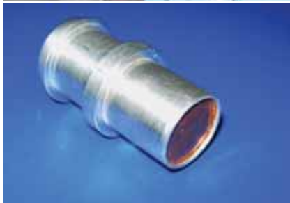
Նկար 9. Վերևվում՝ Mo/Tc իզոտոպներ ստանալու համար պատրաստված փորձարարական սարքավորումը, ներքևում՝ MoO 3 -ի փոշիով լցված թիրախը
