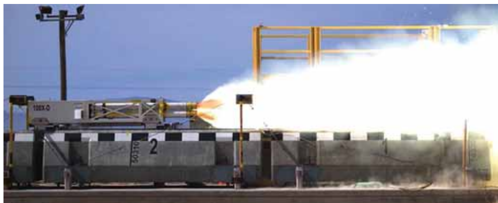
Նկ. 6. Ռեակտիվ շարժիչով և մագնիսական կախոցով գնացքի փորձարկումը
