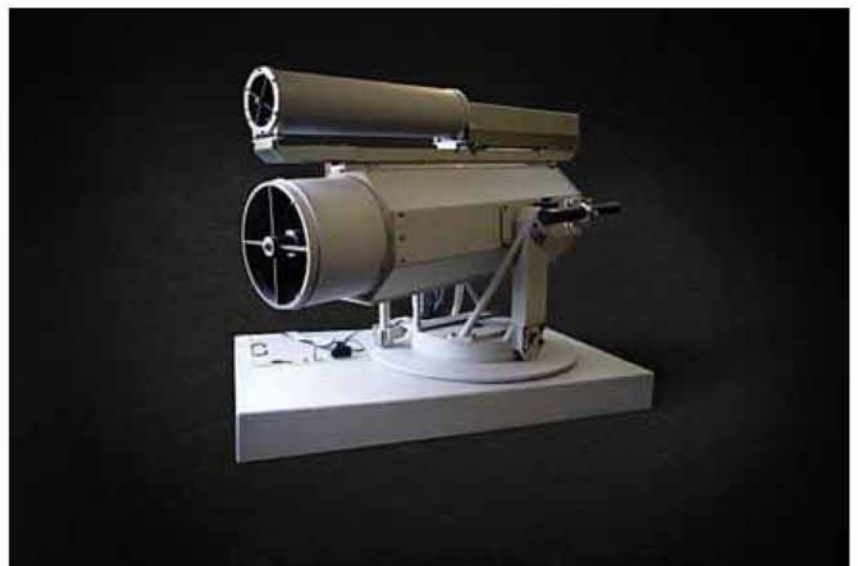
Նկար 13: Հայկական ԼՏ-ՊԻՐԿԱԼ ձեռնարկությունում արտադրված միջին ԵՎ տիրույթի (1.4 – 4.2 մկմ) լիդար՝ մթնոլորտային աղտոտվածության մշտադիտարկման համար
