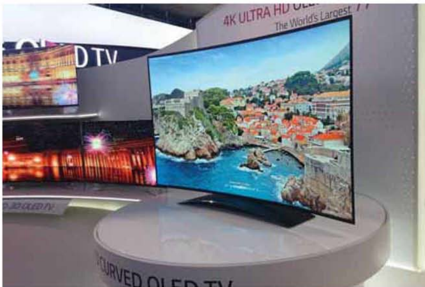
Նկ. 10: Նոր սերնդի բարակ ու կոր հեռուստացույց՝ պատրաստված օրգանական լուսադիոդային (OLED) տեխնոլոգիայով
