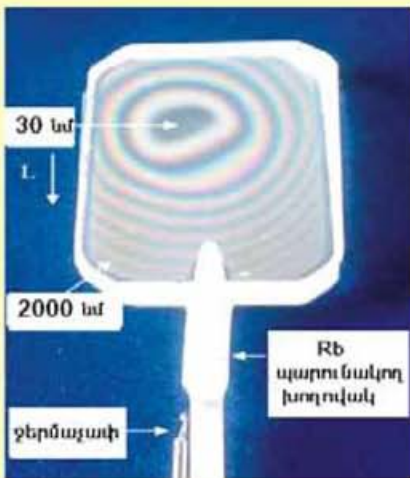
Նկ.1 Մետաղական ուրիդիումի գոլորշիներով լցված նանոբջջի լուսանկարը: Երևում են ինտերֆերենցային գծերը, որոնք առաջանում են նանոբջջի ներքին մակերևույթներից անդրադարձած լույսի ինտերֆերենցի հետևանքով և փաստում են, որ բջջի պատերի միջև հեռավորությունը տեսանելի լույսի ալիքի երկարության (մի քանի հարյուր նմ) կարգի է:
