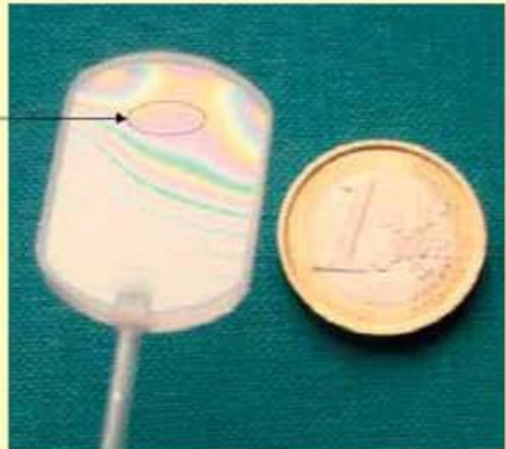
Նկ.4 Մետաղական ցեզիումով լցված նանոբջջի լուսանկարը: Երևում են ինտերֆերենցային գծերը: Շրջանակով նշված է 426 նմ հաստությամբ տիրոյթը (ցեզիումի ատոմների L = \lambda/2 հաստությունը), որն ունի կարևոր կիրառական նշանակություն: 1 եվրո մետաղադրամը բերված է չափերի համեմատության համար:
