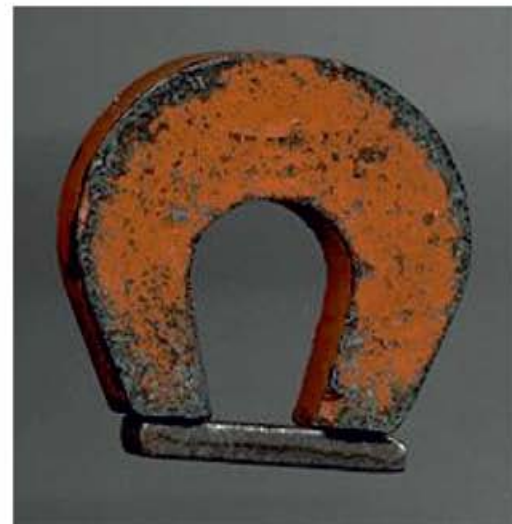
Հնագույն պայտածև մագնիս (բևեռները փակված են երկաթյա թերթիկով)
