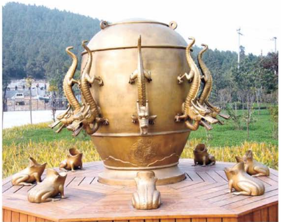
Նկ. 3. Չինացի աստղագետ Չժան Խէնի սեյսմասկոպը
