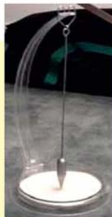
Նկ. 1. Մեխանիկական սեյսմագրիչների կառուցվածքը
