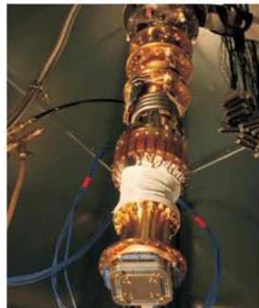
Նկ. 4. «Orion» պրոցեսորն իր կրիոգեն սառեցման համակարգով
