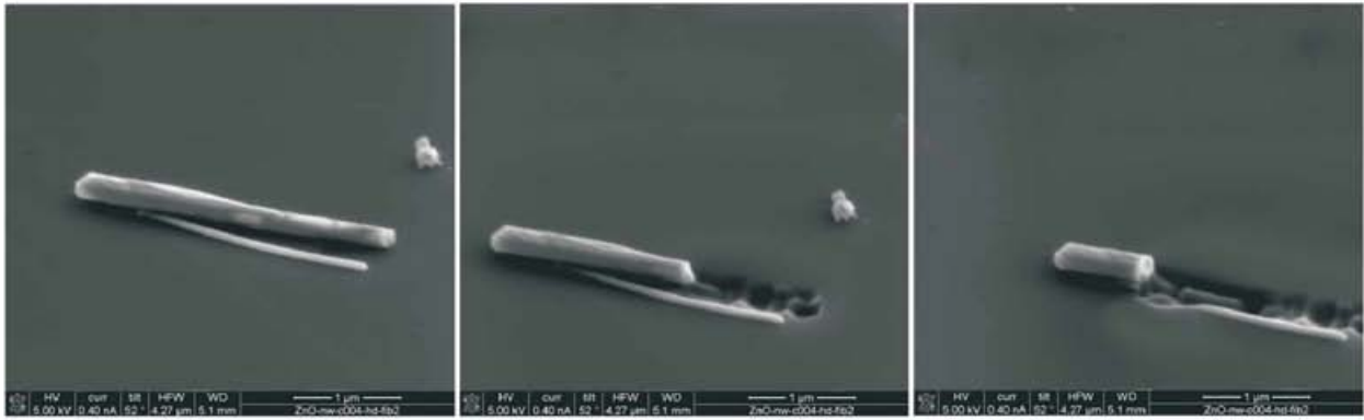
Նկ. 19. ՖիՓ խածատումով աստիճանական հատված ZnO նԼ-ի ՏԵՄ պատկերները, երբ Ga + իոնային հոսանքը կազմում է 1 պԱ
