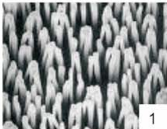
Նկ. 1. Նանոկառուցվածքների տեսածրող էլեկտրոնային մանրադիտակային (ՏԷՄ) պատկերներ, 1 - նանոլարեր, 2 - նանոկետեր
