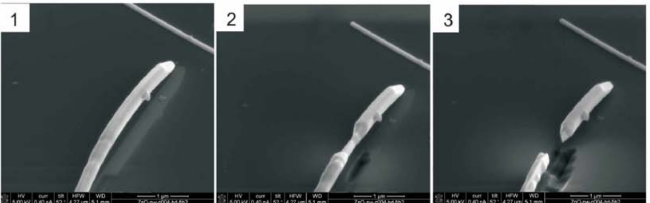
Նկ. 18. ZnO ՆԼ-ների SEՄ պատկերները ՖԻՓ խաձատումից առաջ (1) և հետո (2 և 3), երբ Ga + իոնային հոսանքը կազմում է 1 պկԱ
