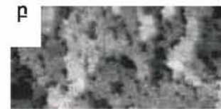
Նկ. 6. Գերբարձր վակուումային տեսաձրող թունելային մանրադիտակի 100 \times 100 նմ 2 մակերեսով Ge/Si-ի պատկերներն աճեցման ա) 300^\circ\text{C} -ի և բ) 430^\circ\text{C} -ի դեպքում (ստացվել են հեղինակի կողմից)
