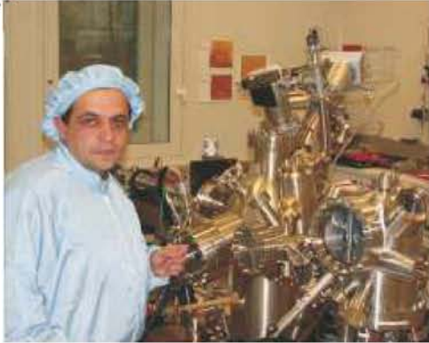
Նկ. 3. Գերբարձր վակուումային տեսաձրող թունելային մանրադիտակը «մաքուր» սենյակում (Գերմանիայի Բրեմենի համալսարան)
