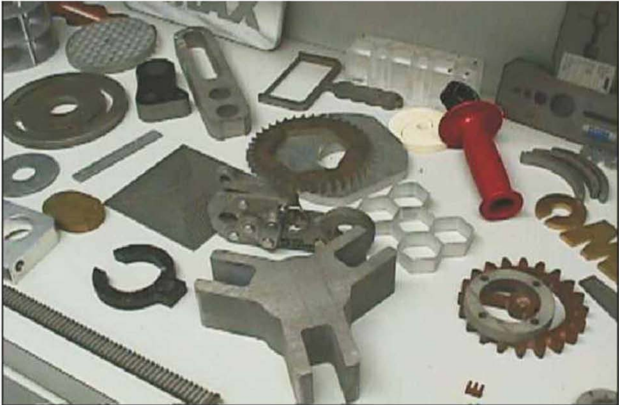
Նկ. 2. Ջրաշիթային և ջրահողկաշիթային կտրմանը ստացված մեքենամասեր
