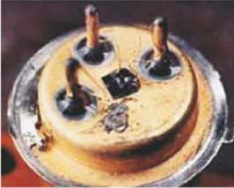
Նկ. 10. Դ. Կանգի և Մ. Արալայի հայրնագործած ՄՕԿ փրանզիստրոնի առաջին օրինակը
