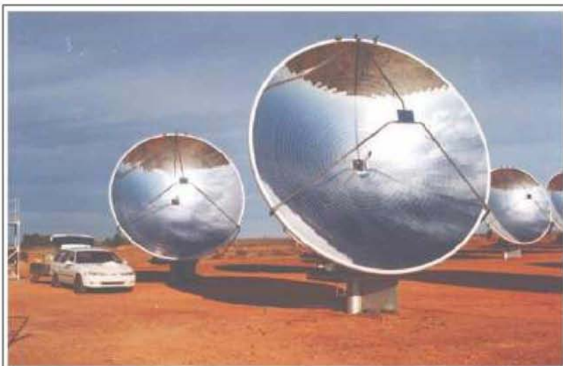
Նկ. 5. Solar Systems կազմակերպության կողմից մշակված պարաբոլահայելային ֆոտոէլեկտրական կայան՝ տեղակայված կենտրոնական Ավստրալիայում
