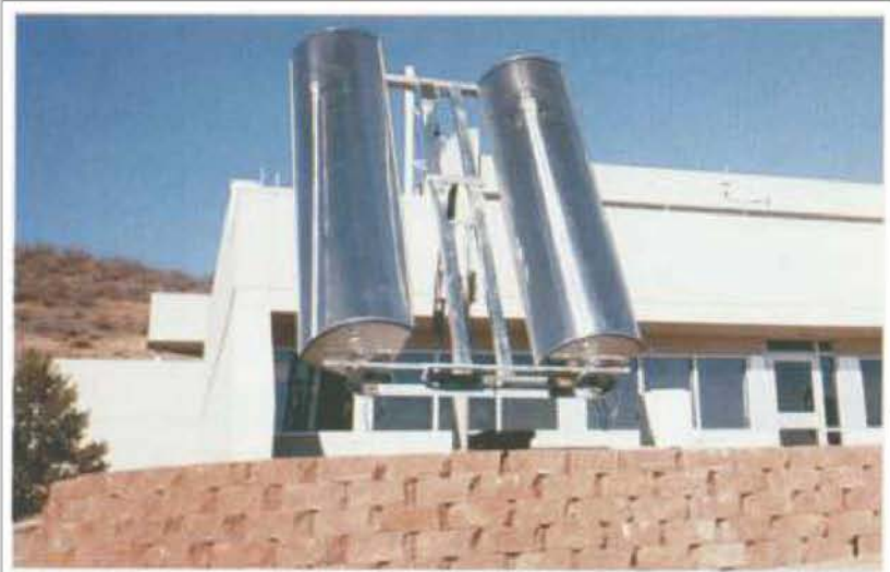
Նկ. 4. ԱՄՆ-ի ENTECH կազմակերպության պարագծի երկայնքով՝ արևային մարտկոցների շարքի վրա Ֆրենեյլային ոսպնյակներով ֆոկուսացվող ֆոտոէլեկտրական համակարգ
