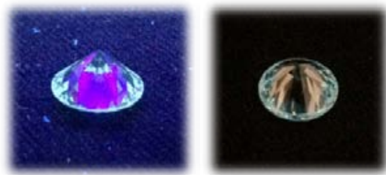
Նկ. 11. HPHT անգույն սինթետիկ ադամանդի բնորոշ լուսածորումը կարճալիքային ճառագայթման տակ (ձախից) և դրա ֆոսֆորեսցենցը՝ լամպն անջատելուց հետո (աջից)
