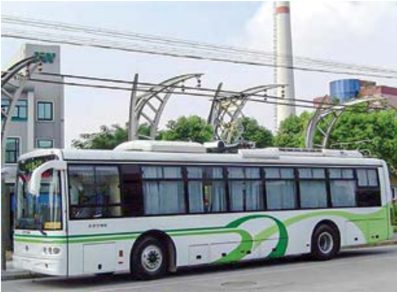
Սկ. 5 Aowei Technology Co. ՍՊԸ-ի՝ Ni(OH) 2 /AC-ի գերկոնդենսատորի հիման վրա ստեղծված տրոլեյբուսը
