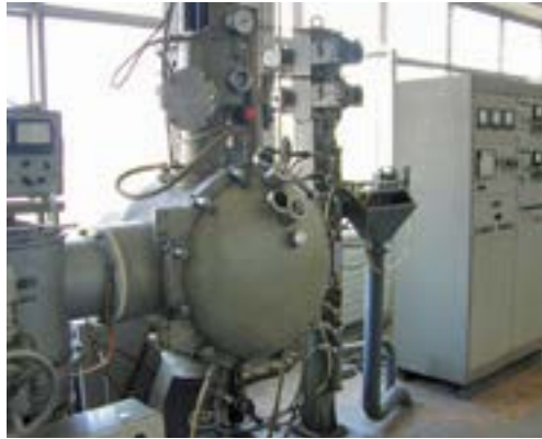
Սցինտիլյացիոն նյութերի լաբորատորիայի բյուրեղների աճեցման սարքավորումը և աճեցված սցինտիլյացիոն բյուրեղների նմուշներ
