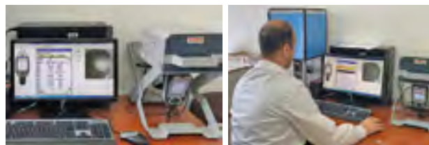
Thermo ընկերության «NITON XL3t 980 GOLDD+» ռենտգենյան ֆլյուորեսցենտային վերլուծիչ
