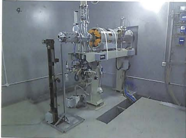
Նկար 9. Ռադիոիզոտոպների արտադրության կենտրոնի մասնաշենքը (ա), բելգիական IBA ընկերության Cyclotron-18 ցիկլոտրոնը (բ), պրոտոնային փնջի արտաքին հոսքագիծը (գ), և պոզիտրոնային առաքումային շերտագրման (ՊԱՇ) սարքը (դ):
