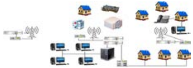
Նկ. 4. WiMax տեխնոլոգիայով հեռաբժշկական ցանցերի միավորման օրինակ
