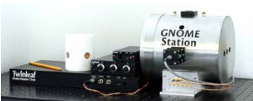
Նկար 6. Էլզտիկ ֆիզիկական երևույթների որոնման համար մագնիսաչափերի համընդհանուր ցանցի (GNOME) ծրագրով մշակված 3 \cdot 10^{-15} Տ զգայնությամբ օպտիկական մագնիսաչափը
