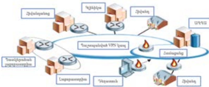
Նկ.1. Կոնվերգենտ առողջապահական հեռաբժշկական IP ցանցի ձարտարապետությունը
