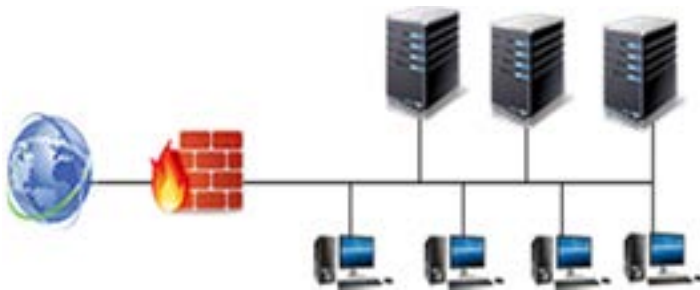
Նկ. 6. Հեռաբժշկական ցանցի պաշտպանությունը միջցանցային էկրանի կիրառմամբ
