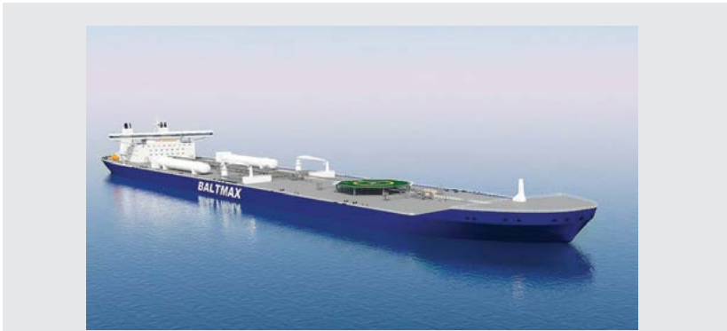
Կռիլովյան կենտրոնում մշակվել է սահմանափակ թաղվածքով և էներգախնայող խոռոչներով 180–200 հազար տոննա սահմանային բեռնունակությամբ տանկերի նախագիծ: Մշակվել է հատակի տակ օդային խոռոչներով փոխադրանավը սառույցներից ազատելու տեխնոլոգիա:
