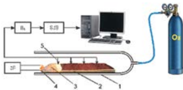
Աղ. 1. Լաբորատոր ԻԲՄ սարքավորման սխեման. 1. քվարց խողովակ, 2. քվարց պնակ, 3. ելանյութերի փոշենյութի խառնուրդ, 4. շիկացման պարույր, 5. ջերմազույգ, ՀԲ՝ հարուցման բլոկ, Ու՝ ուժեղարար, SՀՄ՝ տվյալների հավաքման սարք
